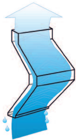
DV 270 是应用于垂直气流的叶片型分离器。 含液滴的气体直接被导入旨在对气流获取最大除雾效果的除雾器箱。
