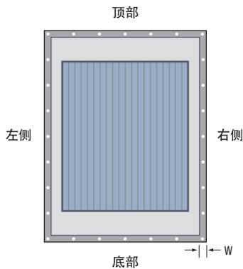
法兰孔型根据 Eurovent、DIN 24193、Norsok 或其它行业、国家或国际标准提供 (指定标准)。同时也提供根据个别需要定制的孔型 (指定钻孔图样和孔径, 提供图纸或在最后一页使用草图)。
