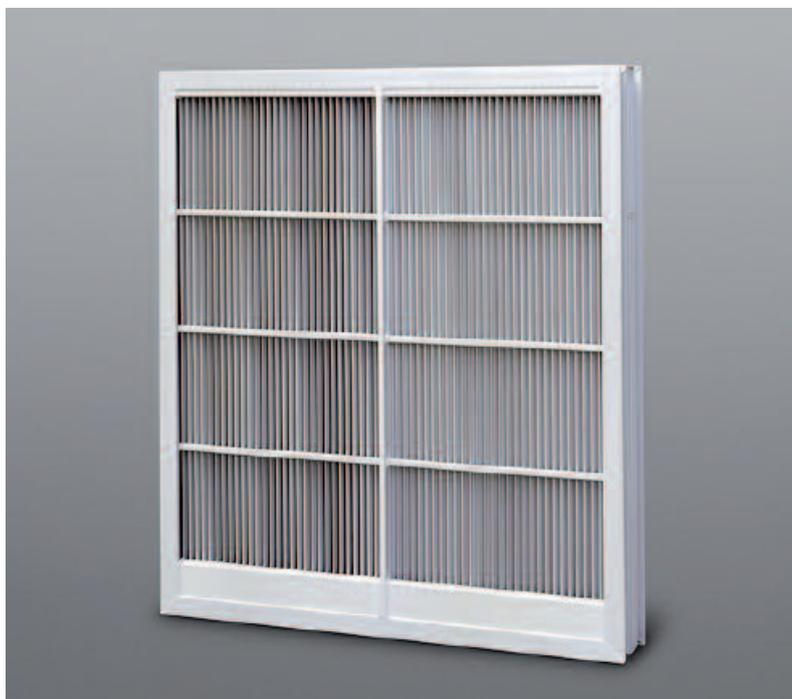
DH 2100-FGD (T 100) 是一种适用于水平气流的叶片式除雾器。载有液滴的气流定向通过除雾器叶片，并被叶片改变方向。由于这样的结构，惯性作用于液滴，液滴撞击到叶片上，形成液膜，在重力的作用下排出。特殊形状的分离室确保液体以正确的方式排放，同时促进精细液滴的分离。这种除雾器通常是面板式设计，应用于烟气脱硫吸收塔中的水平排放区。
